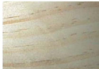
Rabotage de finition suite au rabotage d'ébauche avec un outil RipTec.
