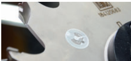
Outil avec support de données intégré.
