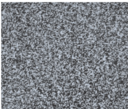
Structure homogène des aciers PM-HS
