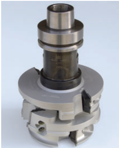
Jeu d'outils avec interface HSK pour changement automatique d'outils
