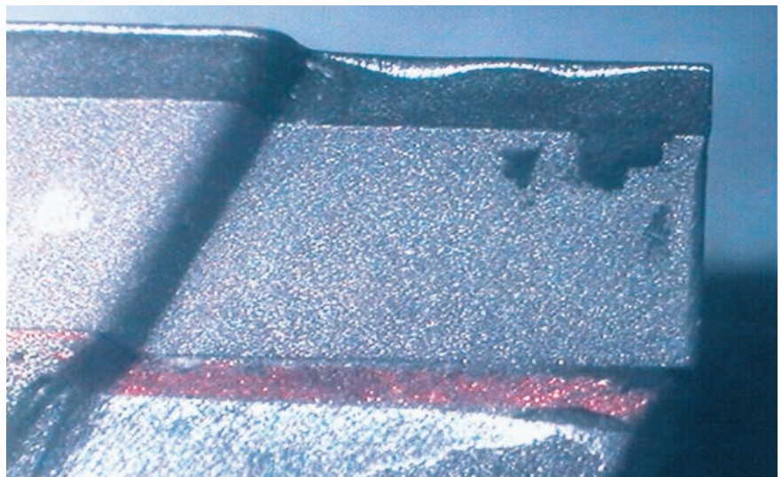
Usure de l'arête tranchante après l'usinage de GFK.
