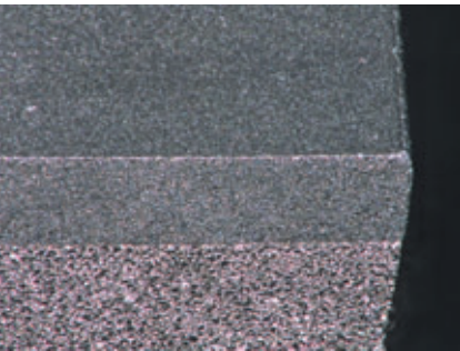
Arête de coupe DP – Couche de diamant polycristallin (haut) fritté sur un substrat de carbure (bas)
